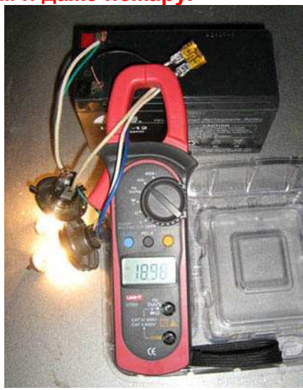
Пример китайского предохранителя 5А, который держит все 19А !!!
