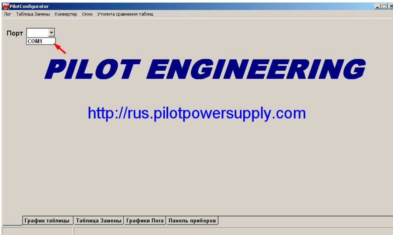
Рис. 4 Выбор порта, к которому подключен конвертер
